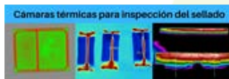
Visión Artificial con rechazo de bolsa con defecto de soldadura
